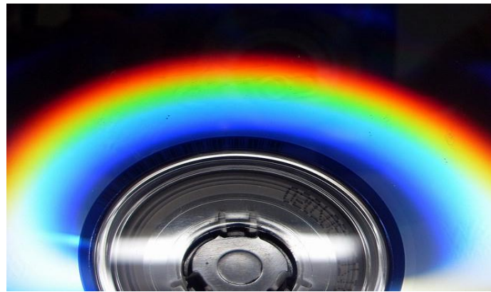
Figura 2: Decomposição da luz em suas cores componentes no fundo de um CD comum.
